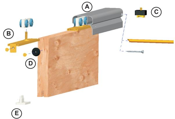
Aluminium Beschlag fur Innen- und Auenanwendungen. Leichtgangig, kugellagert. Montage innenliegend verdeckt bzw. auenliegend zur Vorsatzmontage.
