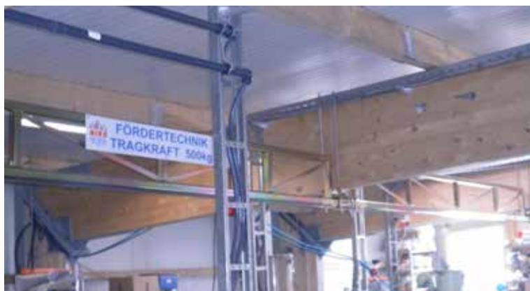
Schienenabhängung mit Aussteifungen Typ. 045
