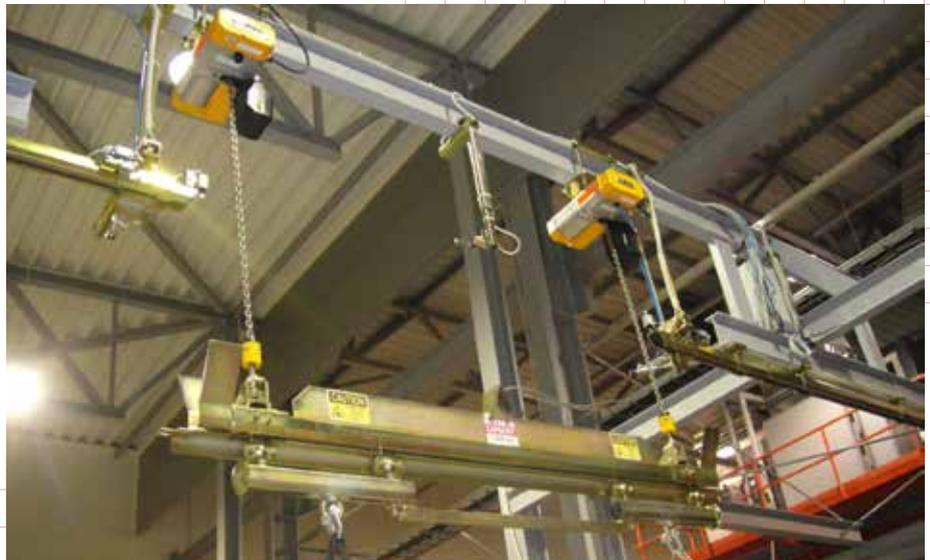
Tragkraft 1 300 kg Länge = 2 500 mm
