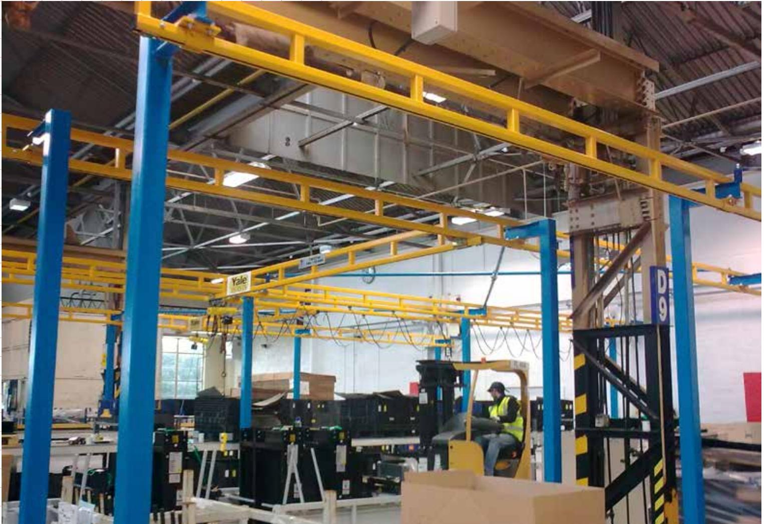
Mehrfach Kranbrücken mit offener Konstruktion
