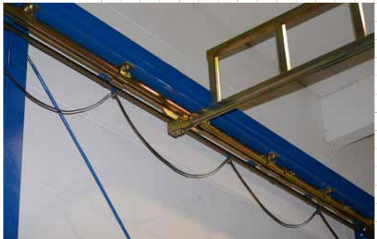
Funktionelle Energiezuführung mit Kabel
