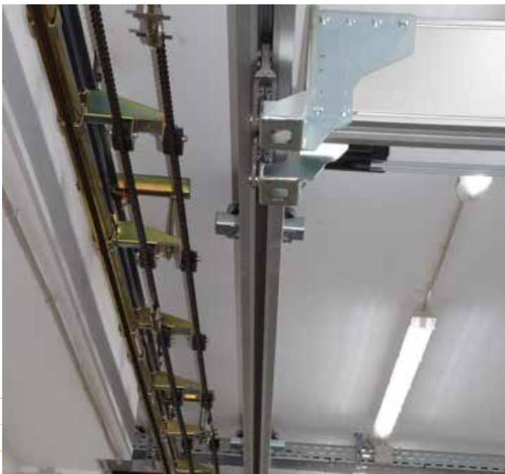
automatisierte Rückführung der Leertraversen
