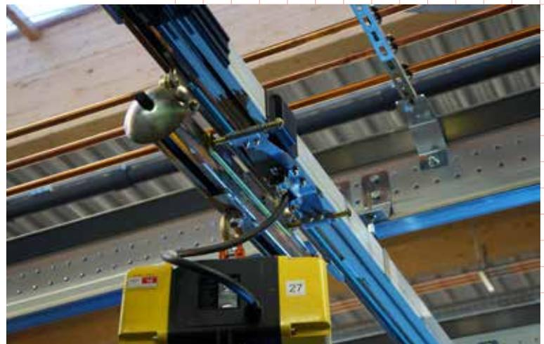
Hebezeug mit Energiezuführung
